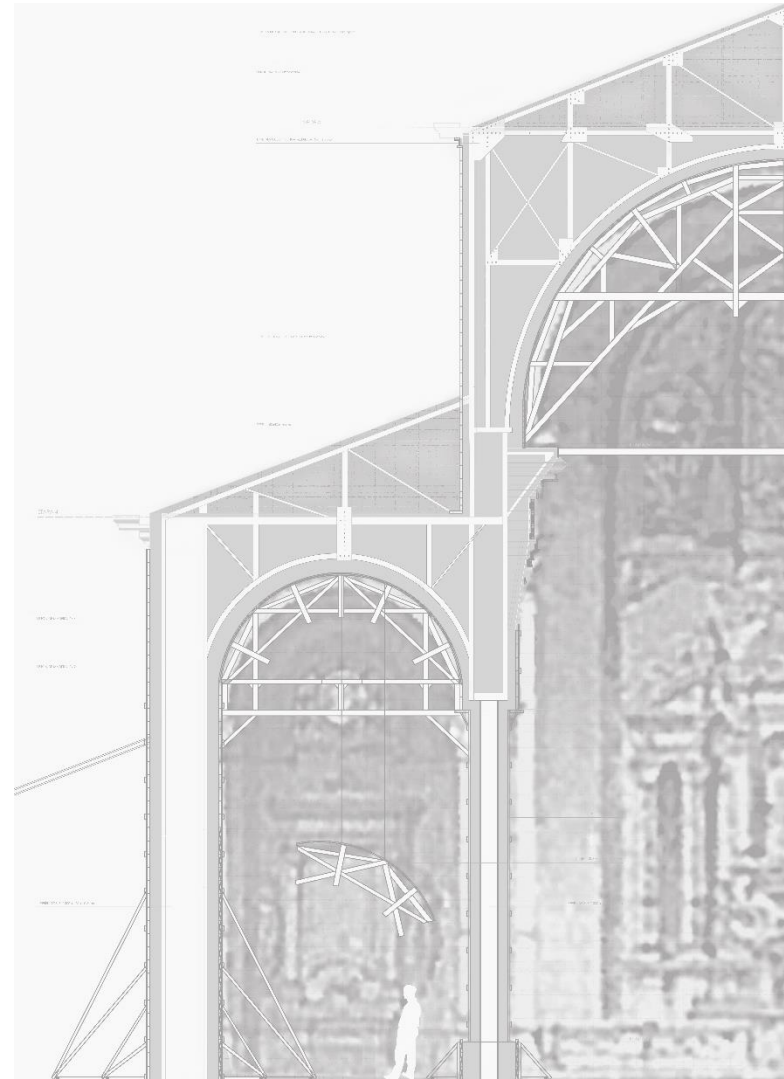
Ilustración 32: En este se puede apreciar la construcción de las naves central y lateral del templo en ella se pueden ver las enfierradura y los moldajes utilizados.
