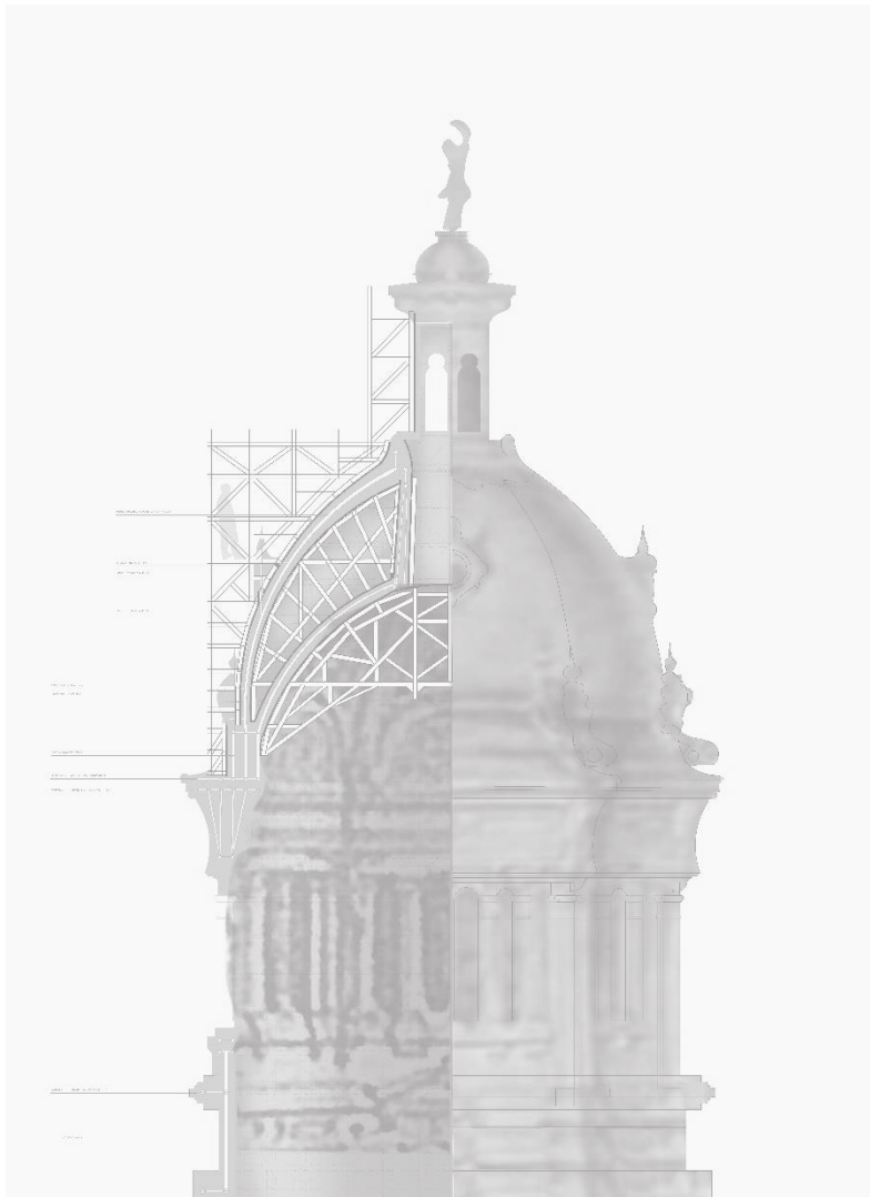
Ilustración 31: Elaboración propia. En este se puede apreciar la construcción de la cúpula en ella se pueden ver las enfierradura y los moldajes utilizados.
